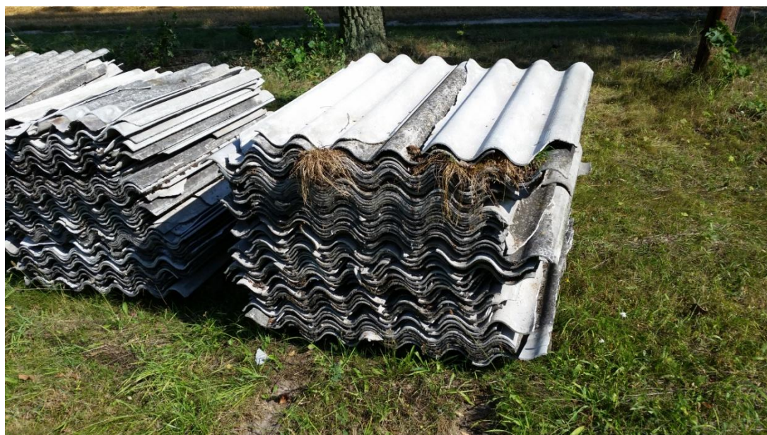
Rys. nr 2 Płyty azbestowe złożone na paletach
