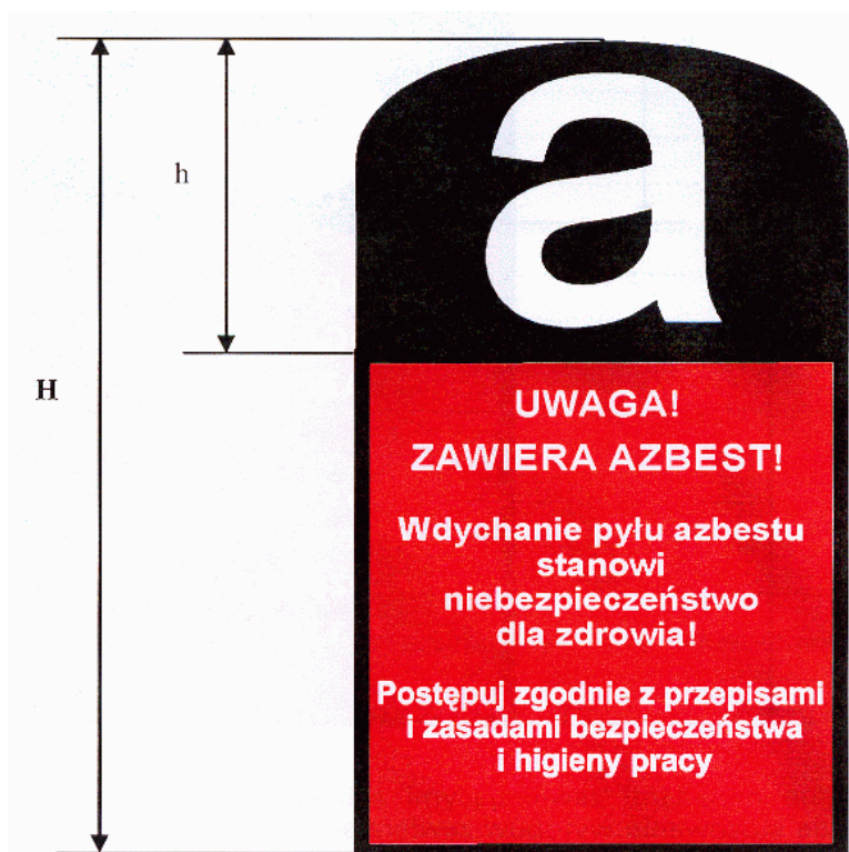
Rys. nr 5. Wzór oznakowania dróg utwardzonych odpadami zawierającymi azbest (H = min. 30 cm).
